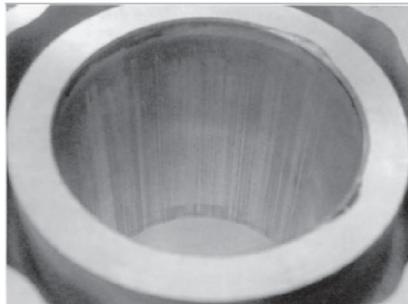
Gambar 1. Keausan pada permukaan *cylinder liner* (Hiroshi Yamagata, 2005).
