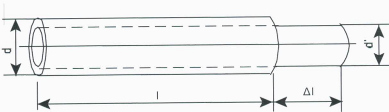
Gambar .4 : Kawat penghantar yang mengalami regangan.
