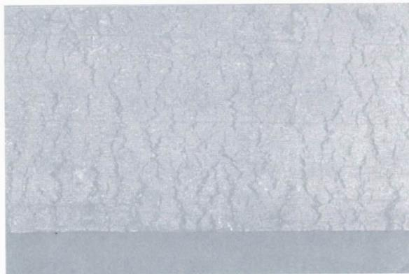
Gambar 3 Retakan pada permukaan pelat kuningan ( $t = 7\text{ mm}$ ) hasil Hot Rolling. Non-etch. Pembesaran 4,5x.
