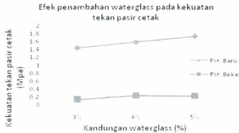
Gambar 4. Pengaruh kandungan waterglass terhadap Kekuatan tekanan pasir cetak baru dan bekas pada cetakan CO<sub>2</sub>-process.
