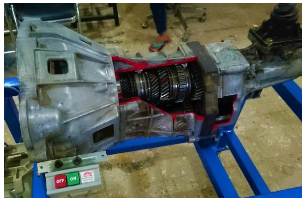
Gambar 3. Transmisi milik Toyota Kijang Innova Tipe E 2.0 M/T yang Digunakan.
