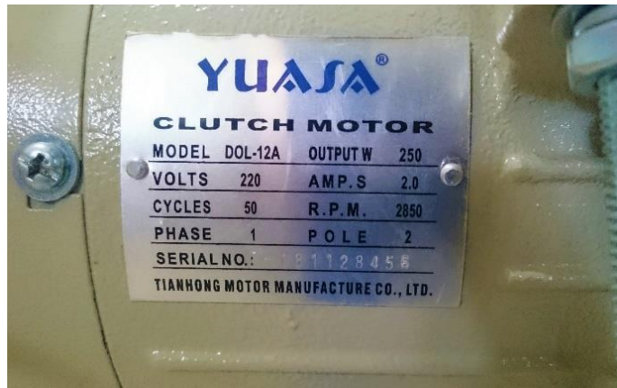
Gambar 5. Spesifikasi Motor Listrik AC sebagai Sumber Tenaga Putar.
