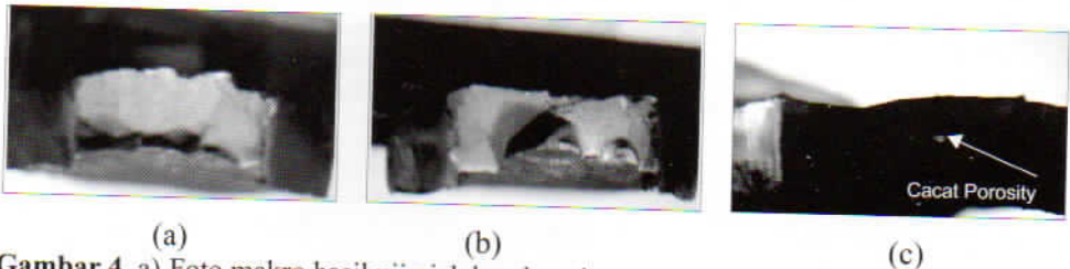
Gambar 4 a) Foto makro hasil uji nick break pada specimen I (arus 80A); b) Foto makro hasil uji nick break pada specimen II (arus 100A); c) Cacat porosity pada daerah weld metal hasil uji nick break
