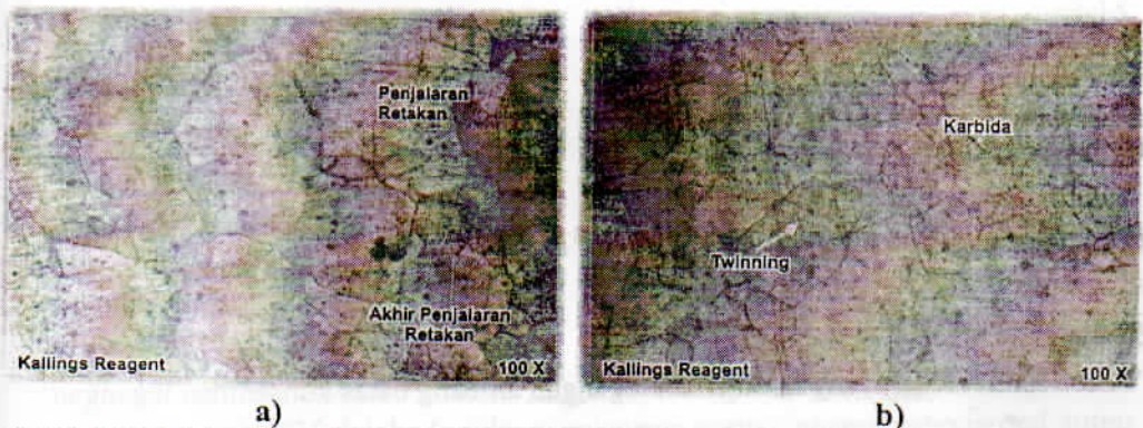
Gambar 13. a) Struktur mikro permukaan patahan daerah ujung retakan b) Struktur mikro permukaan patahan pada daerah jauh dari retakan, karbida M_{23}C_6 yang terbentuk pada struktur austenit dan terbentuknya twinning
