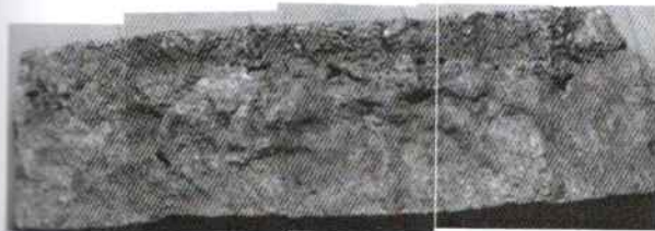
Gambar 6. Permukaan patahan sampel M-I ( stiffener ) memperlihatkan adanya cacat kantung gas ( gas pocket )
