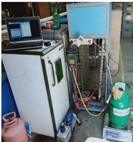
Gambar 3. Set Up Alat Pengujian Mesin Pendingin Refrigerator
