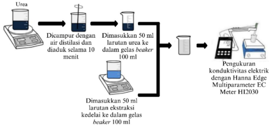
Gambar 2. Skematik Pengujian Laju Hidrolisis
