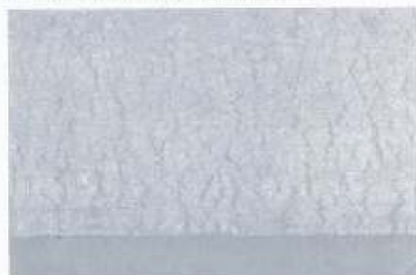
Gambar 3 Retakan pada permukaan pelat kuningan ( t = 7 mm) hasil Hot Rolling. Non-etch. Pembesaran 4,5x.
