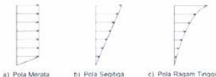
Gambar 2 Variasi pola distribusi pembebanan lateral (FEMA 273)
