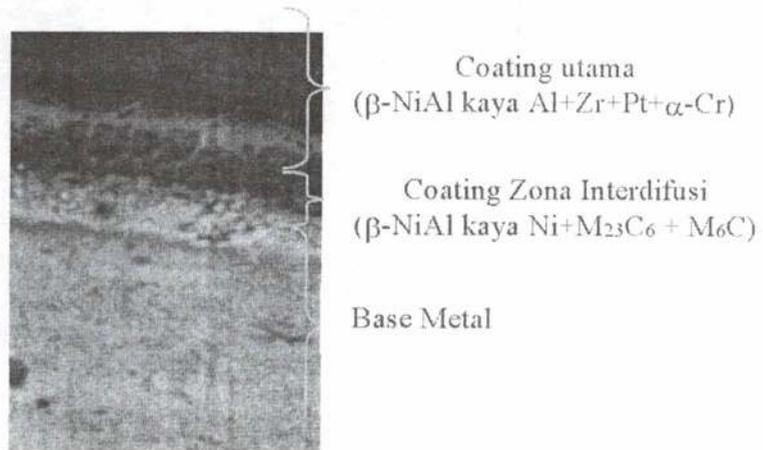
Gambar Profile Coating Menuju Base Metal pada Turbine Bucket
