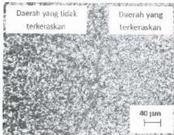
Gambar 12. Struktur mikro bagian inti, fasa ferit (bagian putih) dan perlit (bagian hitam).
