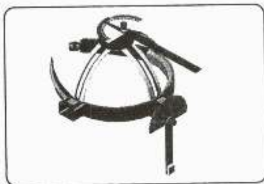
Gambar 2.3 Sketsa alat ukur Anthropometri dinamis untuk sendi leher
