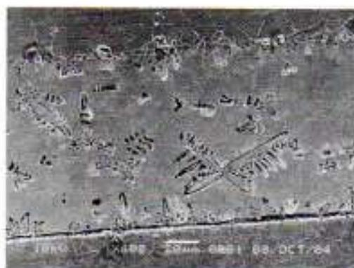
Gambar 14. Struktur mikro daerah sambungan (SEM), 600 X.
