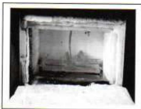
Gambar 5. Spesimen yang telah mengalami proses *brazing* dan siap untuk dikeluarkan dari tungku.
