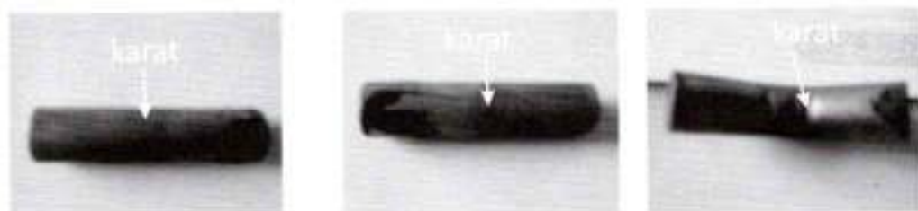
Gambar 3 Kondisi akhir baja setelah dibersihkan: (a) biasa, (b) dipukul, (c) ditekuk
