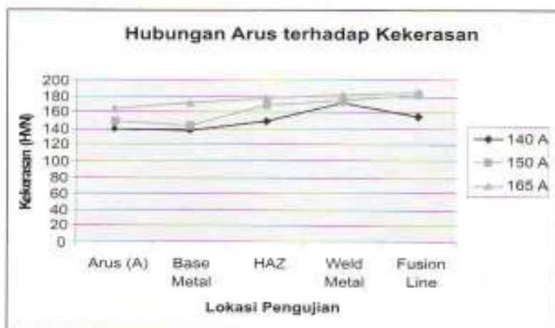
Gambar 4 Grafik hubungan antara Variasi Arus dengan Kekerasan
