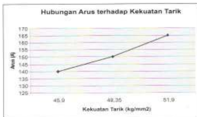
Gambar 3 Grafik hubungan antara Variasi Arus dengan Kekuatan Tarik
