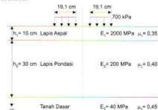
Gambar 4.1. Model Struktur Perkerasan Linier
