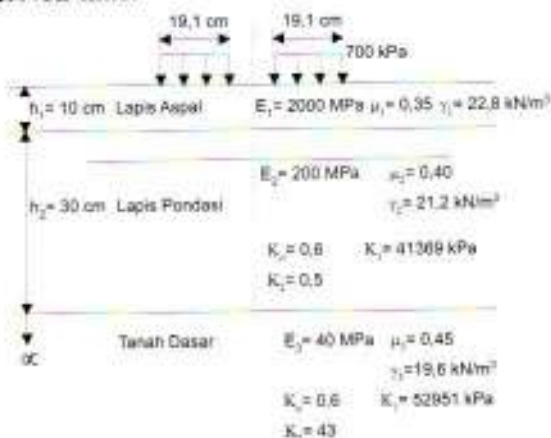
Gambar 4.8. Model Struktur Perkerasan Nonlinier
