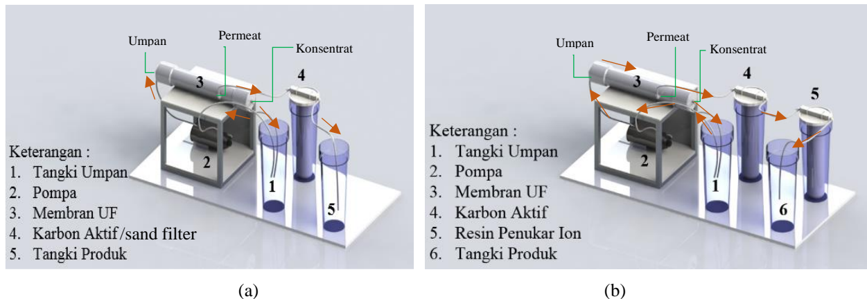
Gambar 1. Rangkaian unit pengolahan air sumur: (a) UF-KA atau SF dan (b) UF-KA-IE
