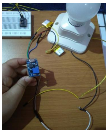
Gambar 13. Pengujian Purwarupa Energy Harvesting dengan Beban Lampu DC 12 V/3 W
