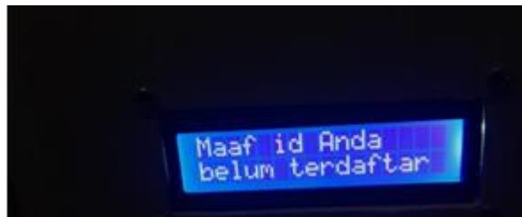
Gambar 10. Tampilan LCD 16 × 2 NFC Reader Memverifikasi Kartu Identitas Pegawai yang Belum Terdaftar
