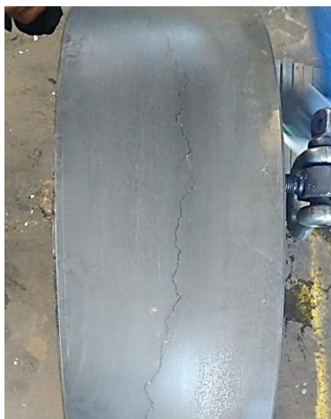
Gambar 1. Komponen Work Roll yang Mengalami Kegagalan.
