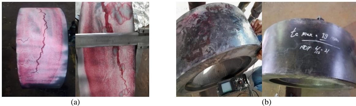
Gambar 9. Kegagalan retak pada komponen work roll setelah dilakukan pengujian tidak merusak (a) dye penetrant dan (b) ultrasonic test
