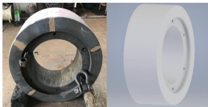
Gambar 2. Komponen Work Roll yang Akan Dilakukan Pengujian Tidak Merusak dan Pengujian Kekerasan.
