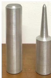
Gambar 6. Elektroda Jarum dan Batang.
