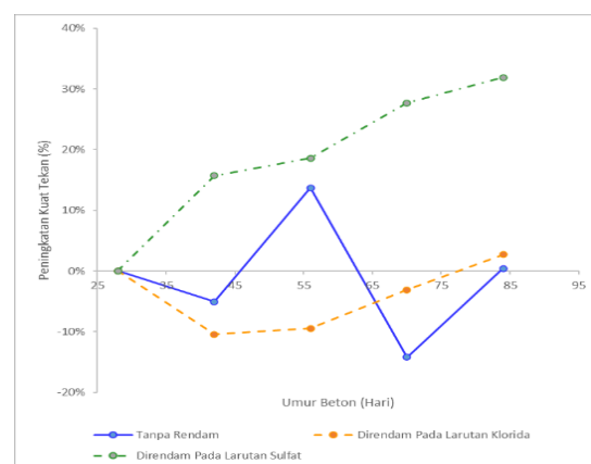
Gambar 8. Grafik Peningkatan Kuat Tekan Benda Uji Semen Tipe II Tanpa Proteksi untuk Setiap Variasi Perendaman.
