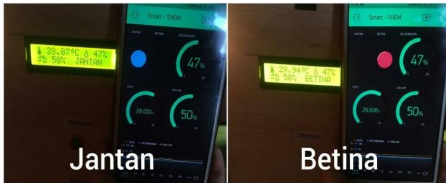
Gambar 9. Proses Pengujian Kesesuaian Monitoring Blynk dengan LCD pada Prototipe.
