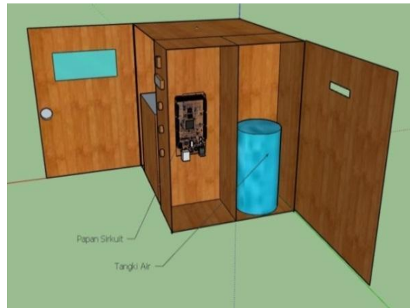
Gambar 2. Tampak Bagian Penyimpanan Tangki Air dan Komponen.
