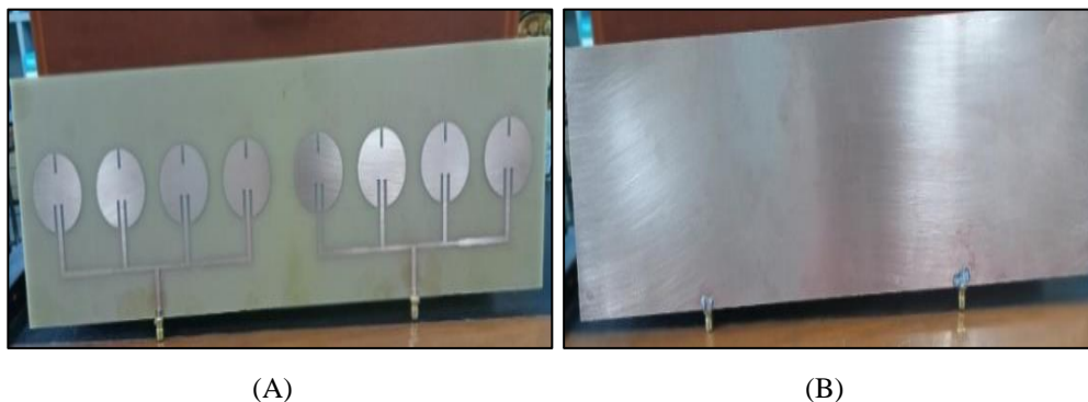
Gambar 27. Tampilan Antena dari Depan (A), dan Belakang (B).
