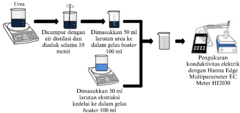
Gambar 2. Skematik Pengujian Laju Hidrolisis
