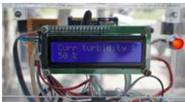
Gambar 10. Nilai Batas Kekeruhan yang Dimasukkan Pada Alat
